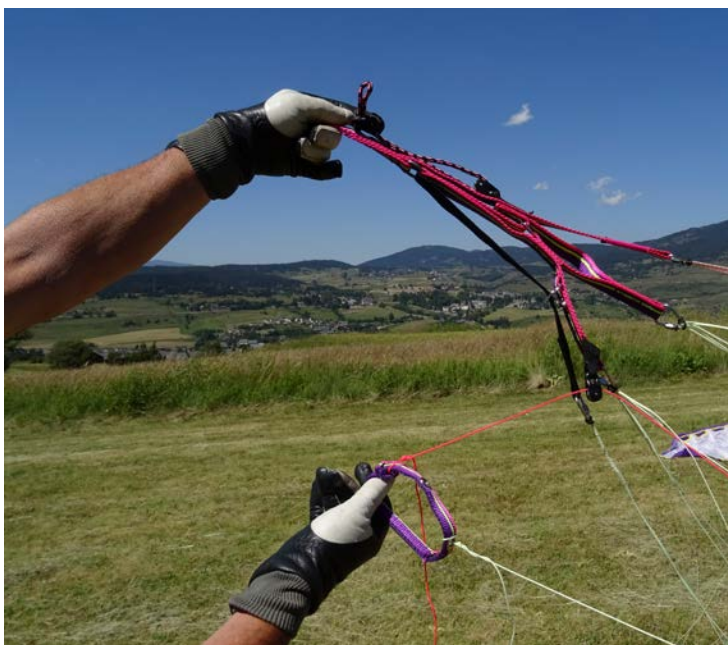
Deux supentes de frein pour une poignée : une suspente va au bord de fuite, une autre au stabilo...
