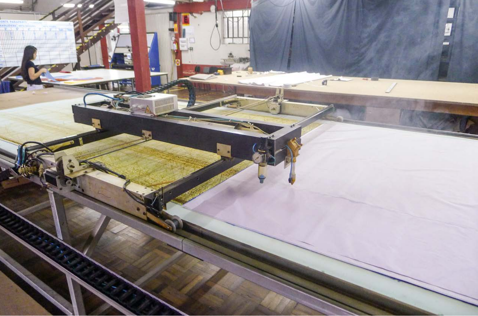
Scènes de la production au Brésil chez SOL (parapentes, sellettes et accessoires). Les gabarits servent à découper le tissu des sellettes.
