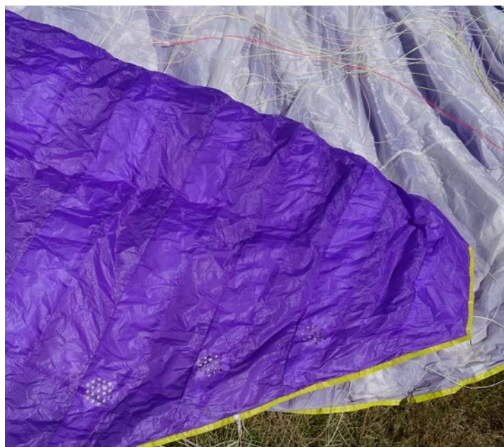
Au-dessus de chaque cloison se trouve donc un réel petit caisson supplémentaire.
