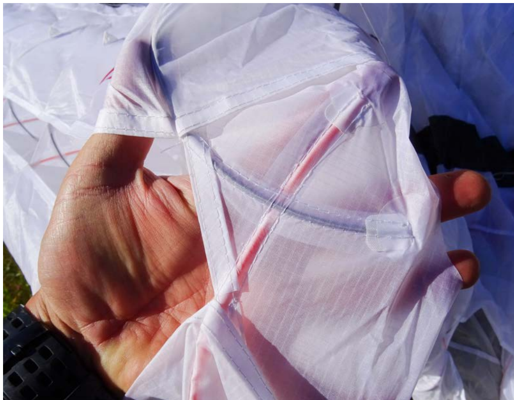
Un joli Shark Nose sur la GIN Sprint 3 que nous avons actuellement en test. Le croisement des Joncs est nécessaire: il faut une certaine courbure aux deux joncs pour exercer une force suffisante.
