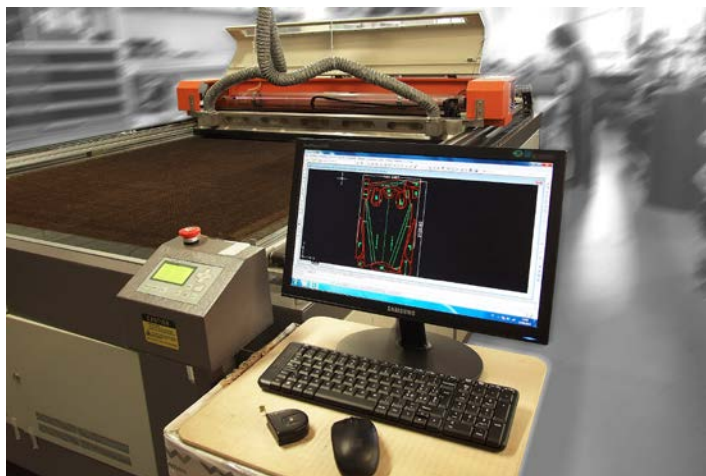
Découpe informatisée chez le constructeur de sellettes Woody Valley - c'est le même principe que pour les profils des parapentes. (Photos Woody Valley)
