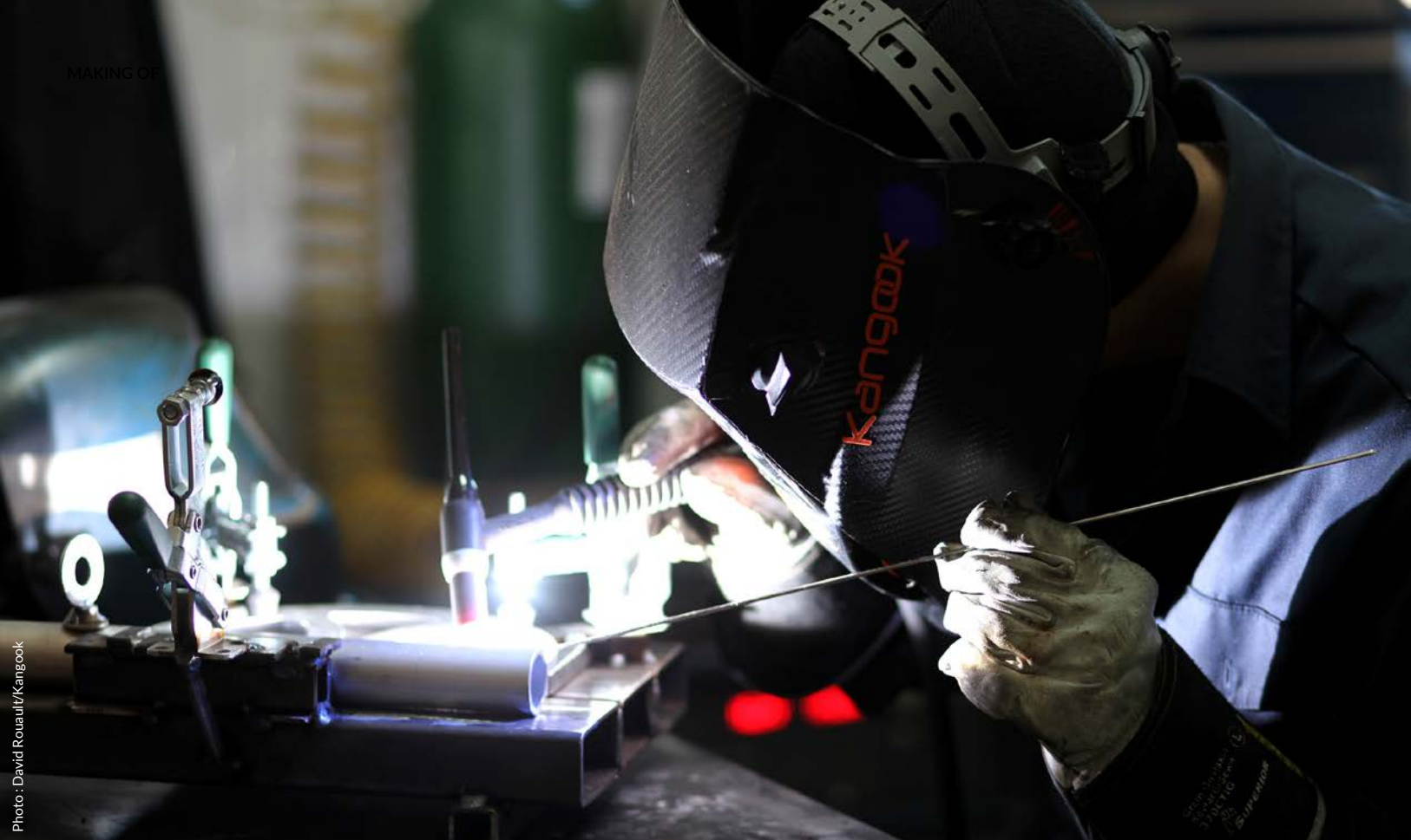
Feu et forces brutes : la construction d'un châssis paramoteur est de nature bien différente par rapport à la confection d'un parapente...
