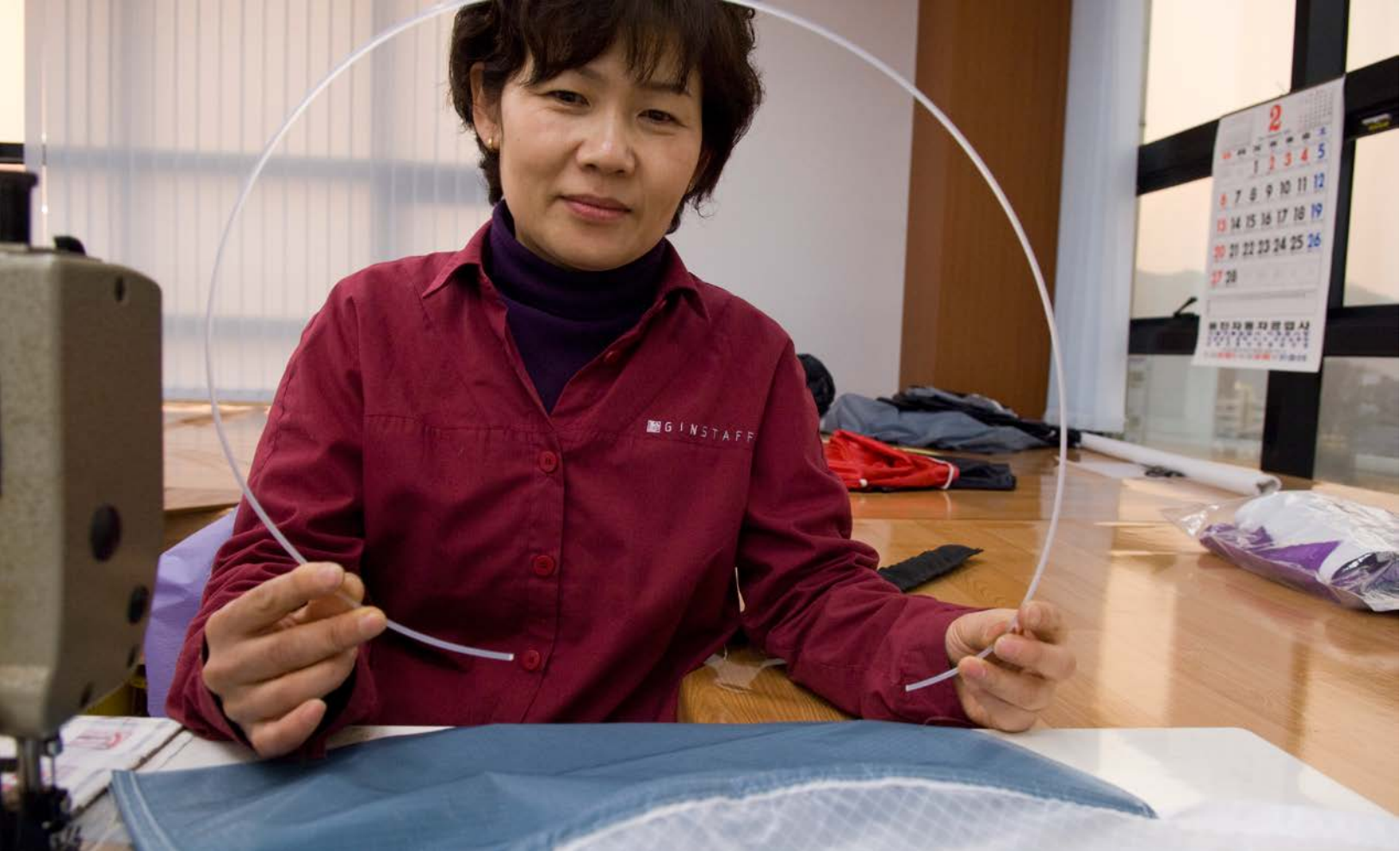
GIN en Corée un jonc juste avant son intégration dans la voile. Photo : Jérôme Maupoint/GIN Les joncs sont devenus omniprésents... Photo du bas : Photo : http://albarsark.com/wordpress
