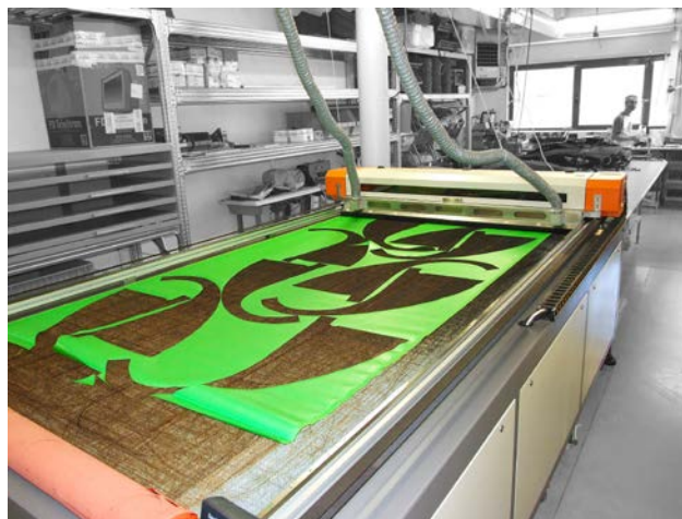
Découpe informatisée chez le constructeur de sellettes Woody Valley - c'est le même principe que pour les profils des parapentes. (Photos Woody Valley)
