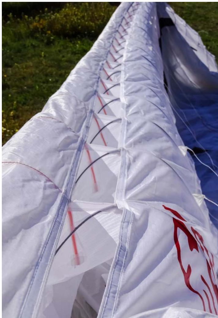
Un joli Shark Nose sur la GIN Sprint 3 que nous avons actuellement en test. Le croisement des Joncs est nécessaire: il faut une certaine courbure aux deux joncs pour exercer une force suffisante.
