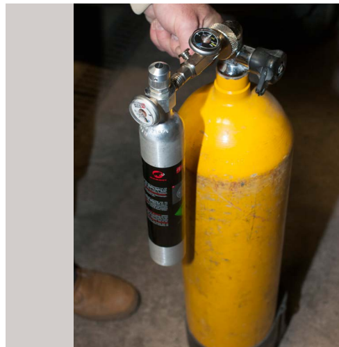
La recharge peut se faire sur une bouteille de plongée grâce à un adaptateur.
