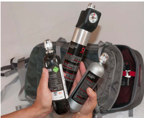
Les trois cartouches proposées : en carbone, acier et rechargeable avec manomètre (310 g, 500 g, 630 g).
