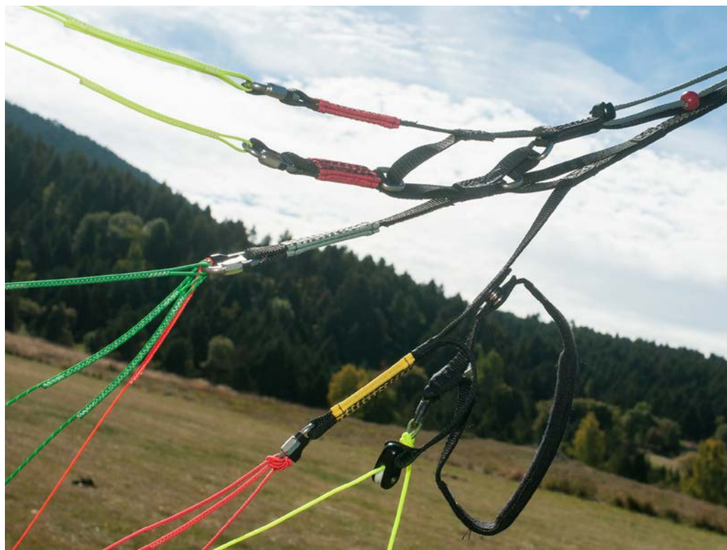
Les élévateurs : A dédoublés, B de couleur différente avec 4 suspentes. La C est également de couleur différente tant pour les 3 suspentes que pour les élévateurs. La suspente de stabilo est également de couleur différente.
