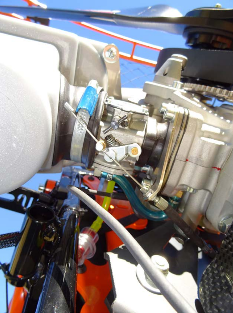
Le carbu à membrane Walbro : comme toujours un élément délicat lors de la mise au point de l'ensemble, mais réclamé (à tort ?!) par de nombreux clients. Mais ce sera un autre sujet...
