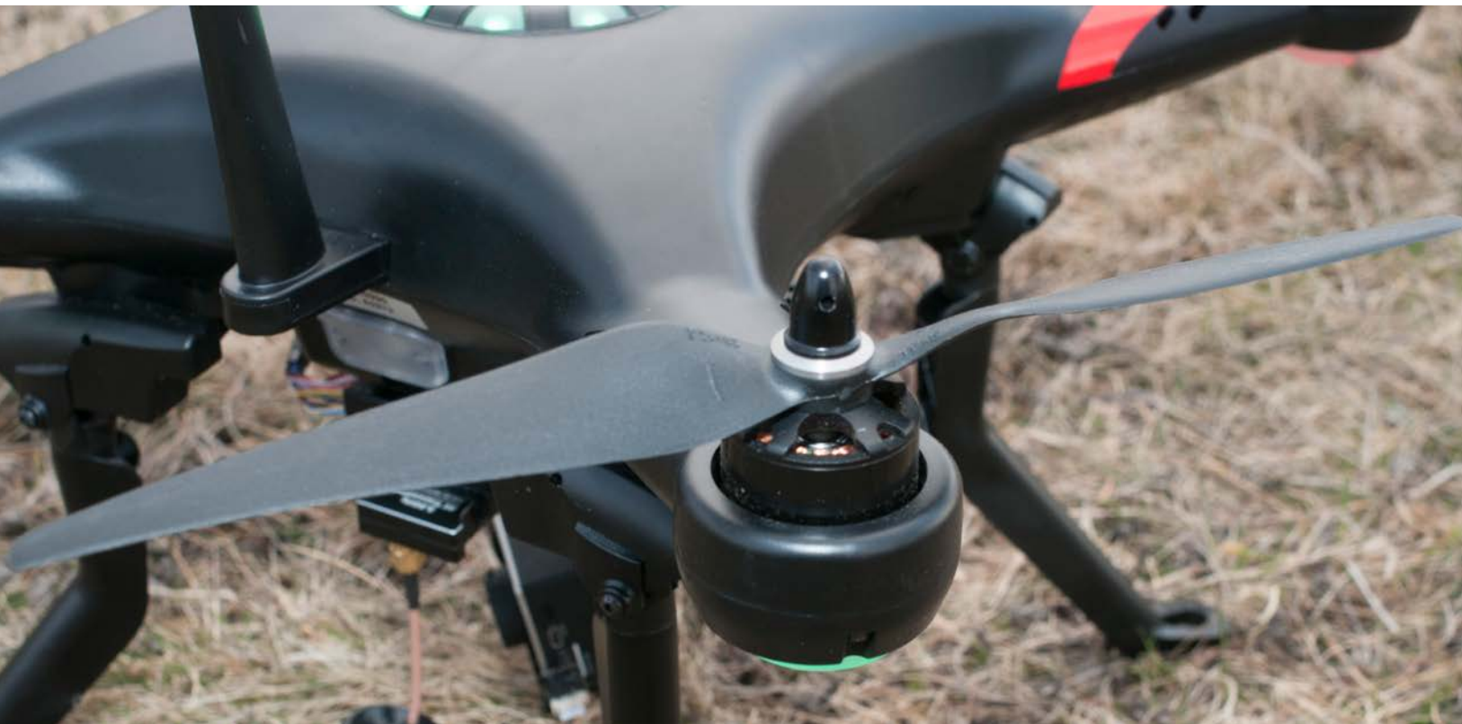
Sur les 4 hélices, deux tournent à gauche, deux à droite, afin d'éliminer tout effet de couple non désiré. Quand il y a de la casse, c'est bien moins cher qu'en paramoteur : l'hélice coûte moins de 20 euros.
