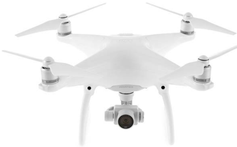
La caméra du Phantom 4 est de technologie propriétaire DJI et intégrée au drone. Poids de l'ensemble: 1380 grammes.
