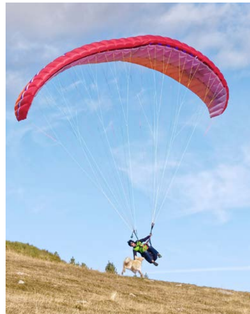
La main à la commande pilote l'éloignement de la pente. Si nécessaire, son activation provoque aussi une petite ressource pour regagner quelques centimètres de hauteur.
