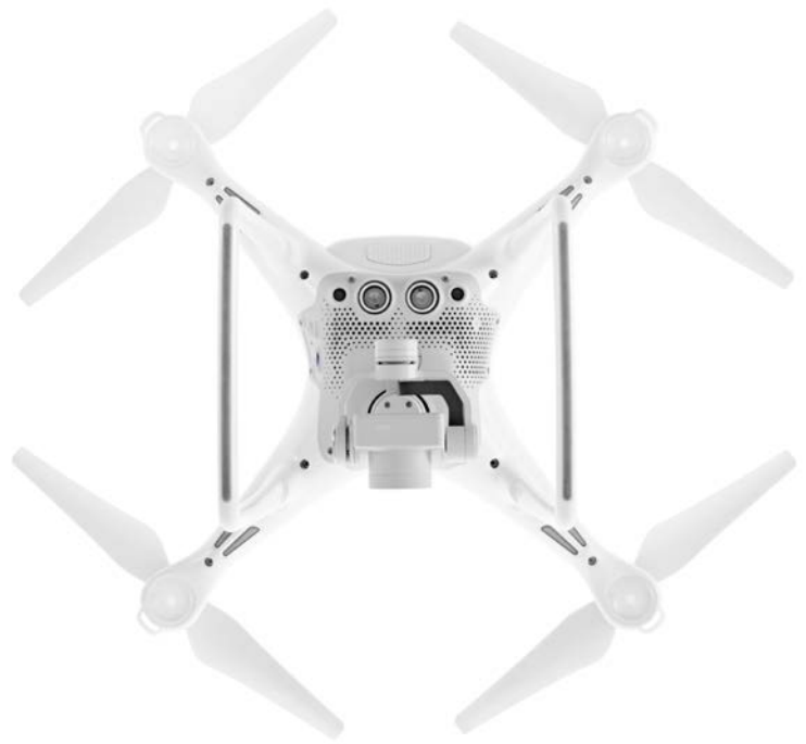
Vers le bas, des capteurs ultrason complètent les capteurs de vision.
