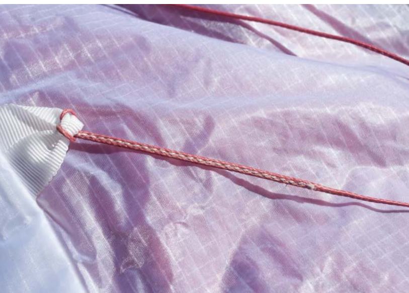
En haut, suspentes non gainées.
