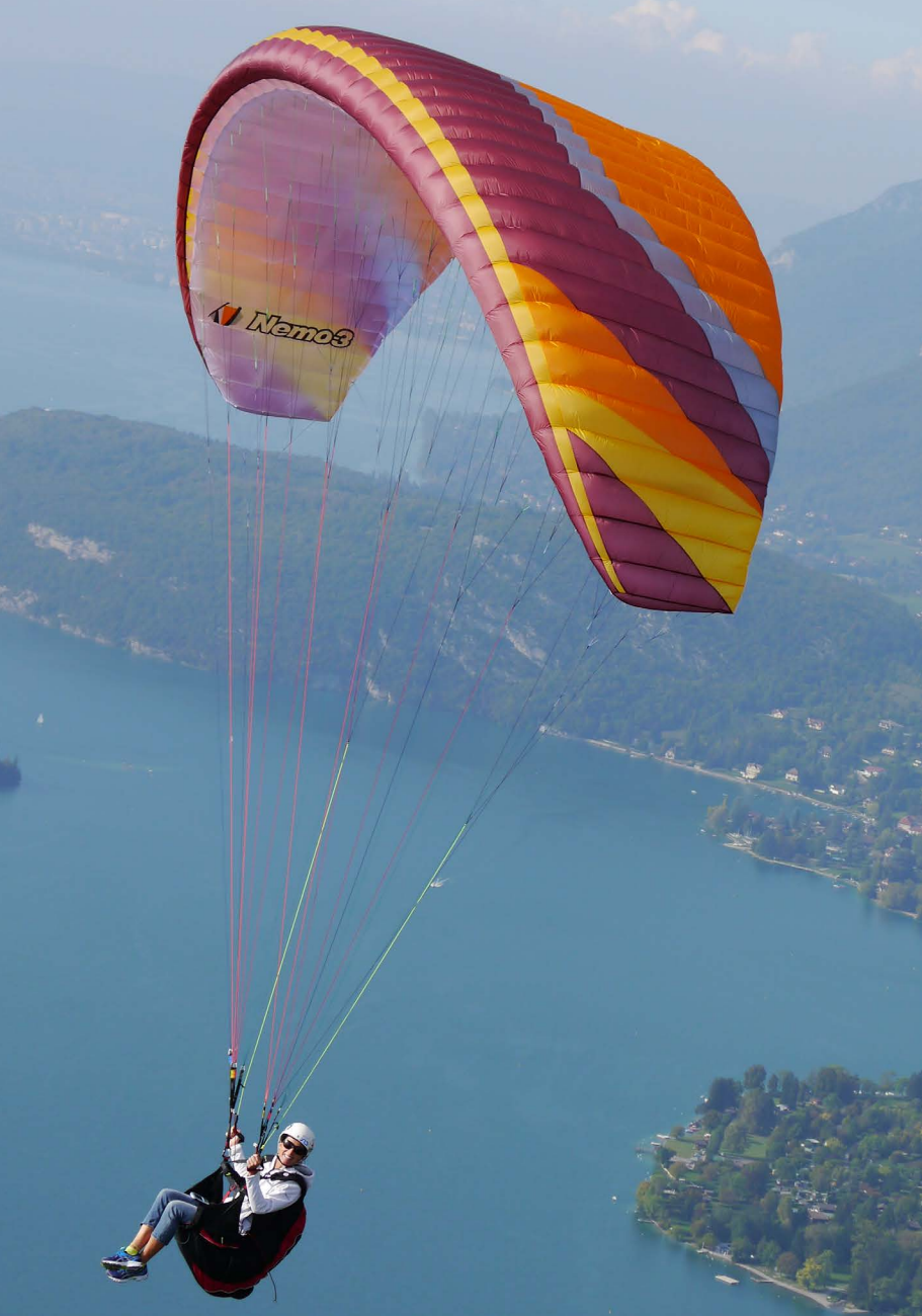
La Nemo XX de Dudek intègre un Shark Nose : cet élément moderne s'invite de plus en plus dans la construction des ailes pour débutants. Photo : Dudek
