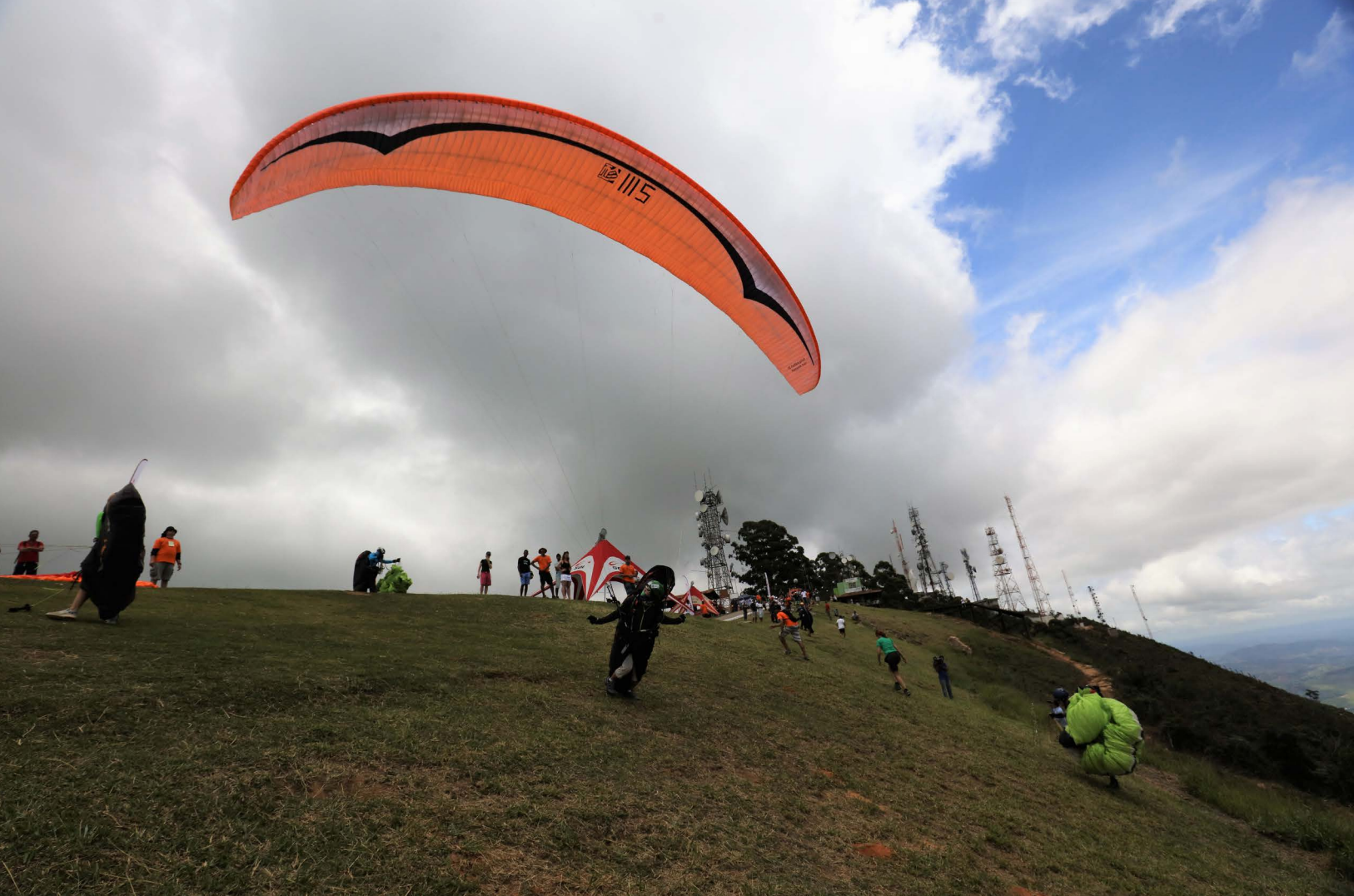
Une GIN Boomerang 11 au décollage. Elle a bien plus de cellules que la Boomerang 10 : 109 dans la version actuelle. GIN ne communique pas encore sur tous les détails techniques de la Boom 11, le modèle étant encore sujet de possibles changements. Le modèle au Brésil est un des premiers modèles homologué selon la "nouvelle" version de la norme CCC. Photo : Laura Sepet
