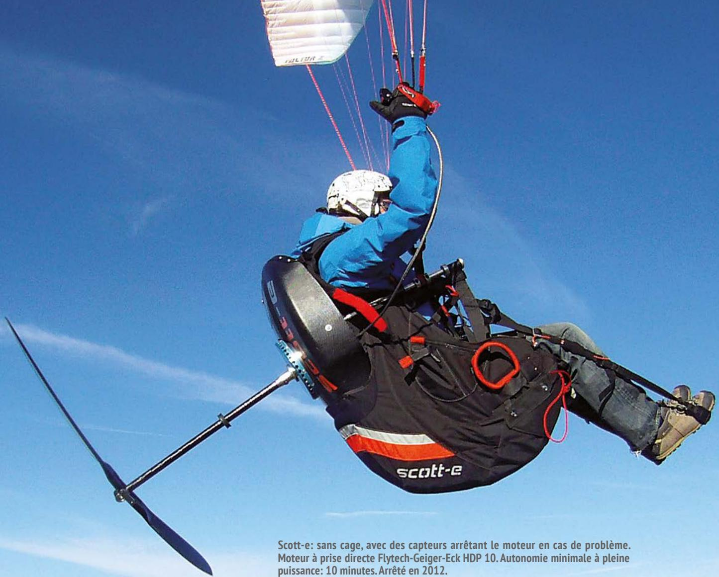
Scott-e: sans cage, avec des capteurs arrêtant le moteur en cas de problème. Moteur à prise directe Flytech-Geiger-Eck HDP 10. Autonomie minimale à pleine puissance: 10 minutes. Arrêté en 2012.
