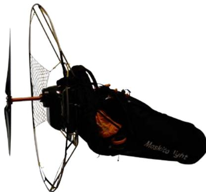
Conçu plutôt comme une aide à trouver le thermique : le Mosquito E-Light de l'allemand FTR. Moteur HQ150 9 kW, poids complet env 25 kg (dont 13 kg l'accu de 37 Ah, autonomie 20 minutes), prix complet avec chargeur et sac de voyage 11000 €.
