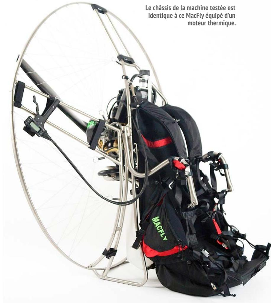
Avec 3 vols d'environ 10 minutes je n'ai pas vidé la batterie ni même atteints la « zone rouge » qui limite la puissance disponible quelque temps avant l'arrêt des machines ». Donc les 30 minutes annoncées pour une batterie de 45 Ah semblent véridiques. On notera qu'une batterie de 63 ou de 73 Ah permet plus d'une heure de vol.
