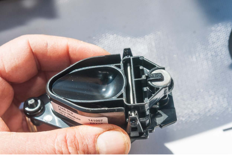
Le système pour la pluviométrie. Dès qu'une quantité précise vient de goutter dans la cuillère, elle bascule et actionne un contact, permettant ainsi à la station de comptabiliser la quantité exacte.
