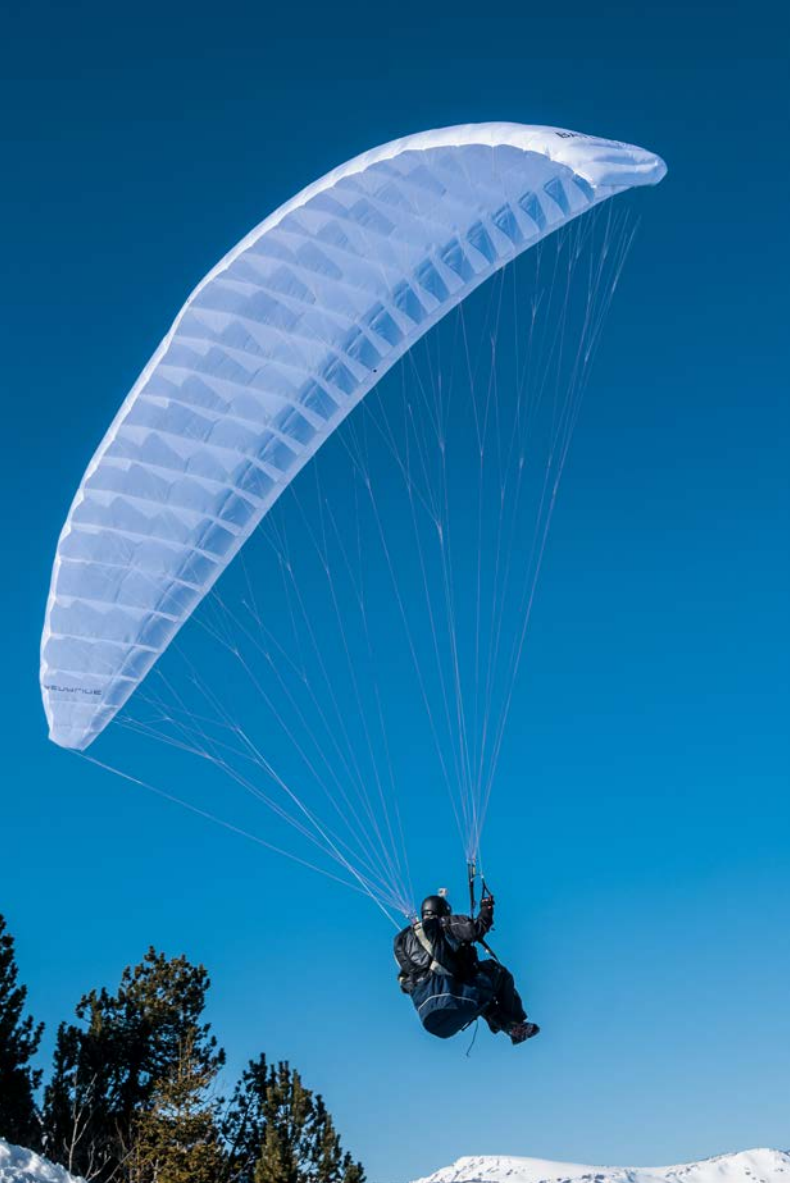
La Batlite de chez Adrenaline : basée sur les plans Barretina, ici lors de nos tests début 2013. La Batlite est l'aile la plus indulgente au niveau pilotage de toutes les ailes single skin. Photo : Véronique Burkhardt
