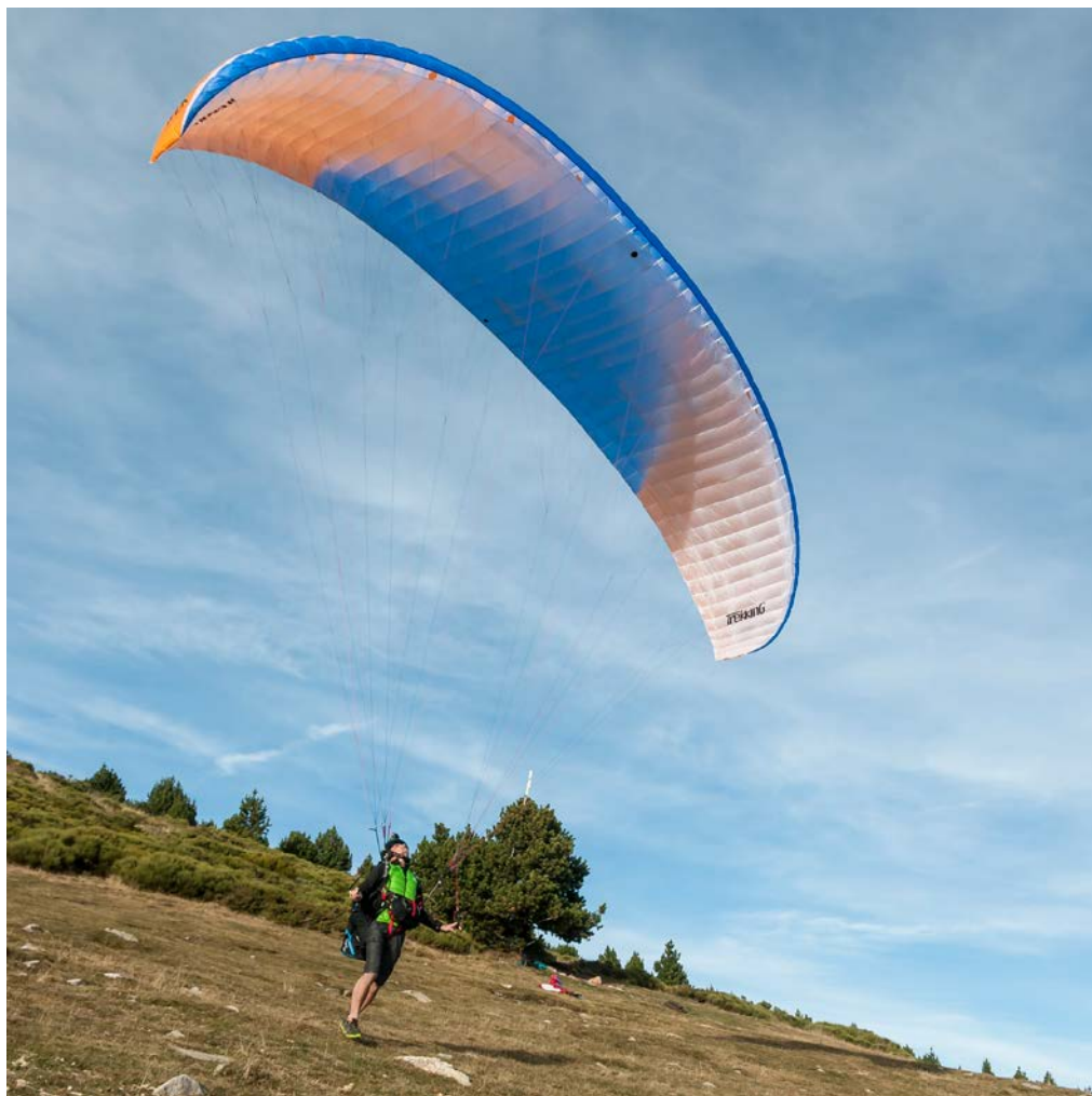
Trekking s'entête par principe : pas de joncs dans le bord d'attaque. Mais comme la voile est légère, elle monte plus facilement que la Senso Classique.
