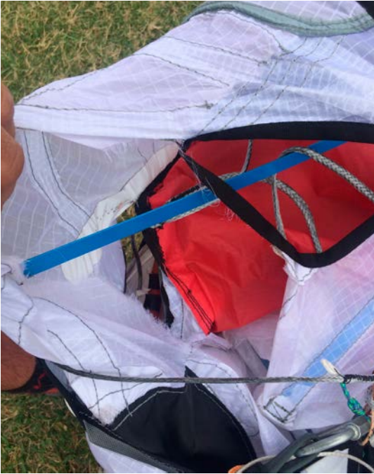
Un des premiers prototypes : c'est le tissu qui lâche, pas le reste ! Photo : Kortel
