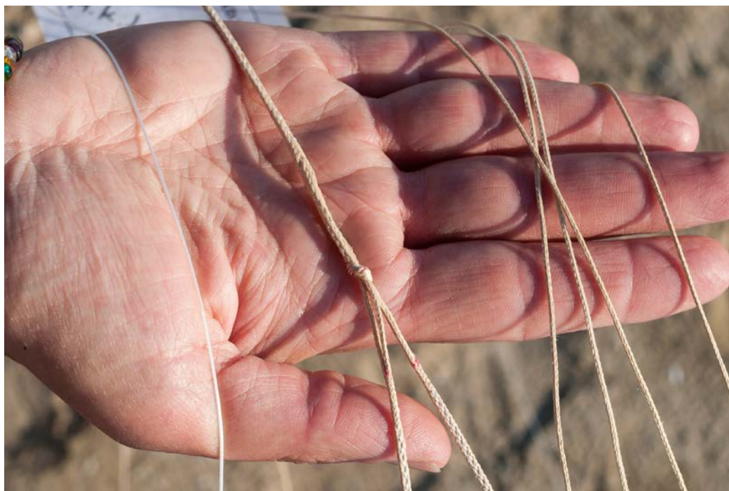
Pour les suspentes non gainées, les fabricants utilisent du Dyneema (en haut), des Aramides (en bas) et du Vectran. Si le Dyneema est souvent blanc et les autres bruns, la couleur ne permet pas toujours de faire la différence. Le Dyneema est dimensionnellement moins stable que les autres fibres.
