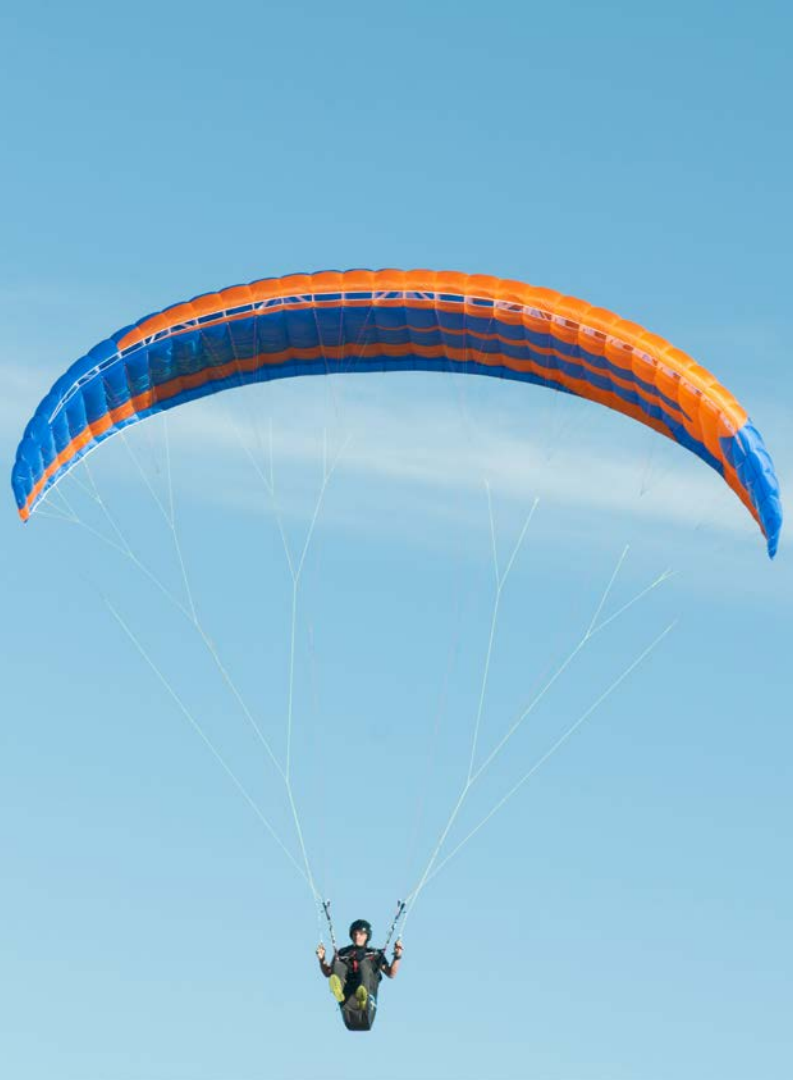
Un allongement de 5.1 à plat et 3.8 projeté.
