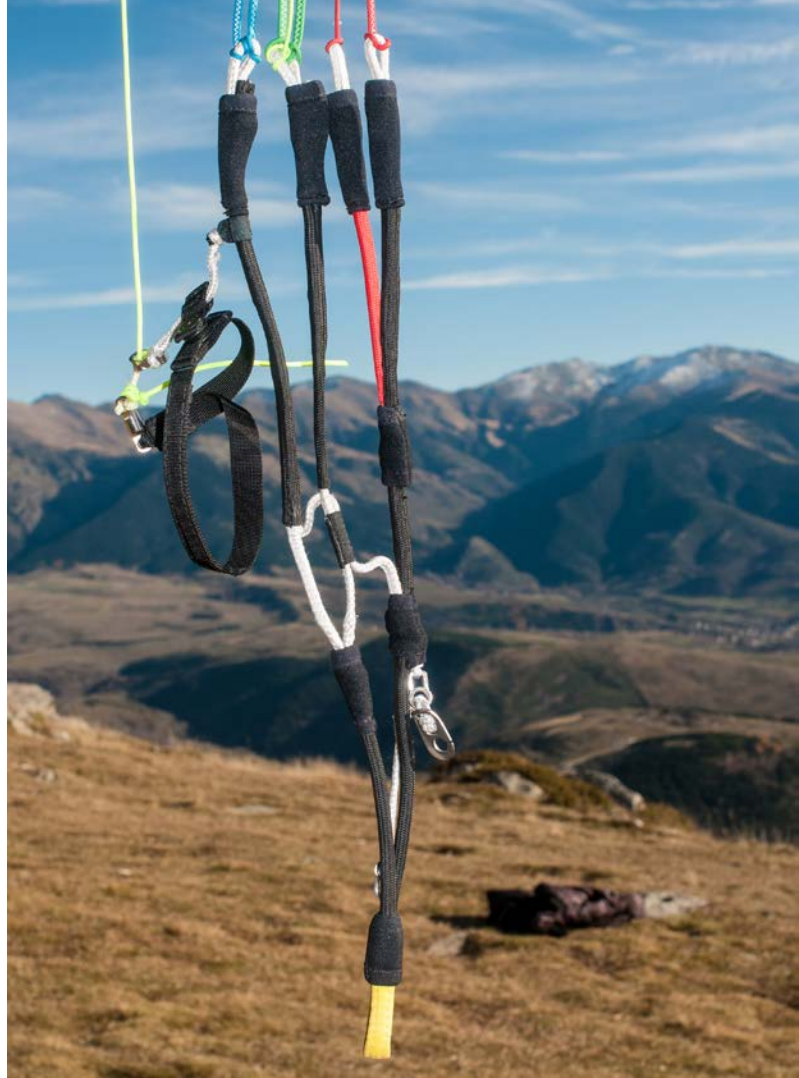
L'allègement est obtenu par le choix du tissu et l'utilisation d'élevateurs en Dyneema.
