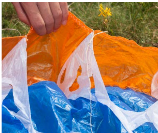
Détails de la Skin Plume : une bonne partie de l'excellente tenue de son profil est sans doute l'œuvre des joncs en Nitinol.
