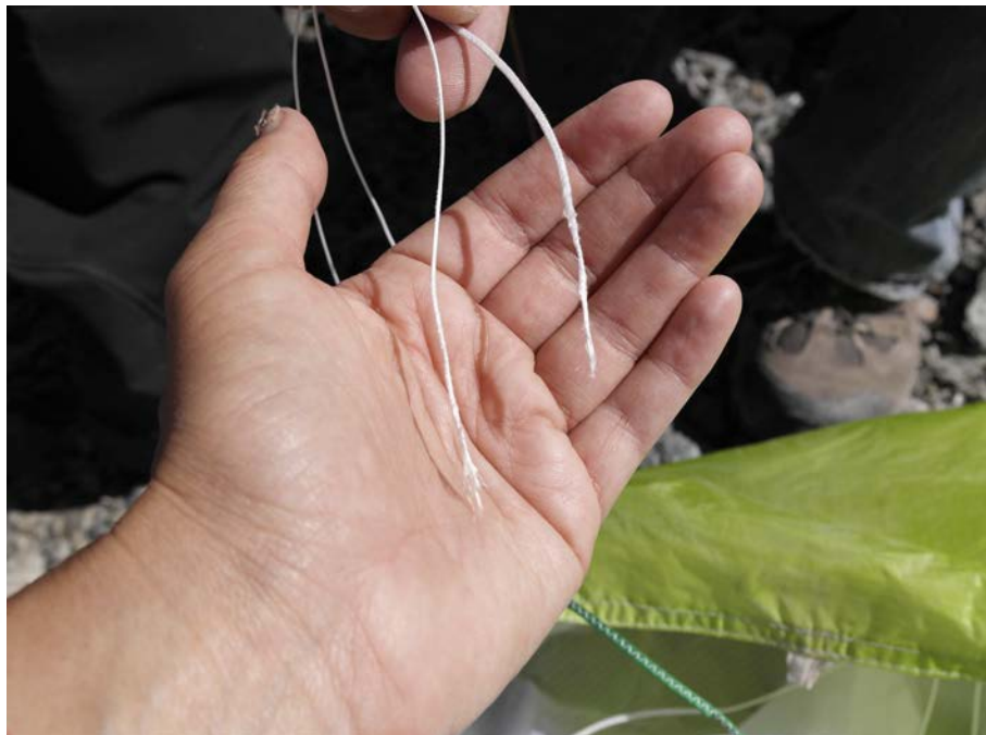
La rupture de suspentes non gainées: cela peut arriver, mais ce n'est pas leur problème principal. Photo: www.profly.org
