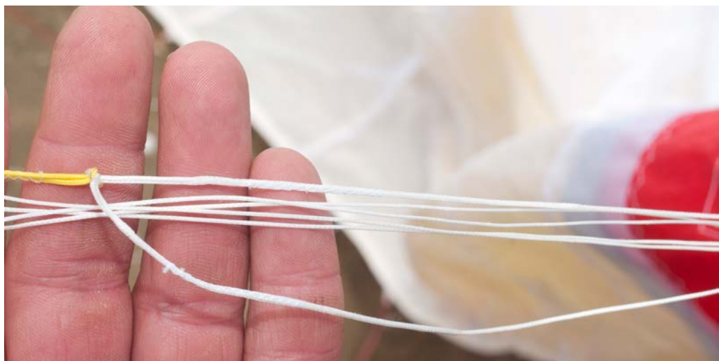
Pour les suspentes non gainées, les fabricants utilisent du Dyneema (en haut), des Aramides (en bas) et du Vectran. Si le Dyneema est souvent blanc et les autres bruns, la couleur ne permet pas toujours de faire la différence. Le Dyneema est dimensionnellement moins stable que les autres fibres.
