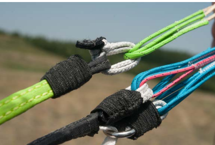
Sur la Plume, la liaison suspentes/élévateurs est assurée par les softlinks "LI-NK" de chez Niviuk.
