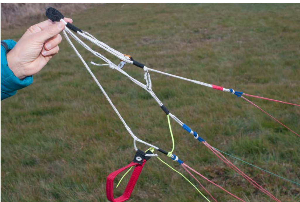
L'élévateur en tresses Dyneema de l'Air Design UFO 16
