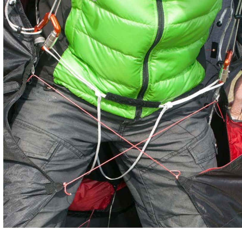
Skywalk Range X-Alps : des drisses Dyneema à la place des sangles
