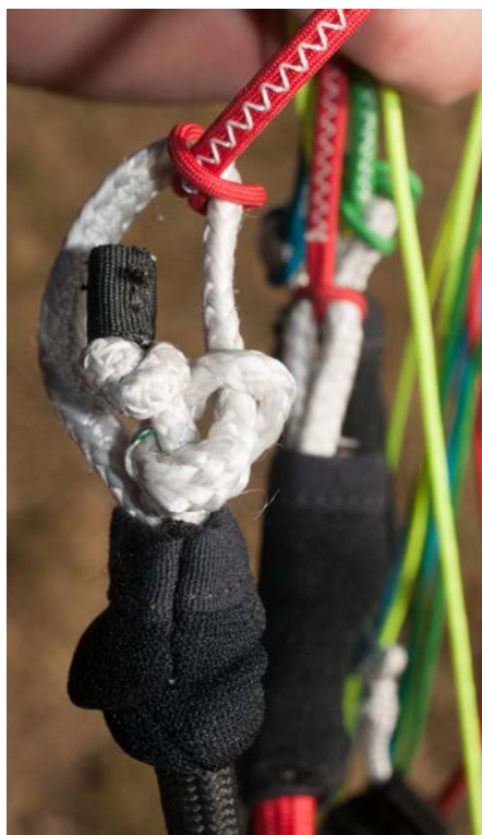
Les softlinks sur la Sitta sont différents : il s'agit d'une tête d'alouette butant contre un nœud d'arrêt.
