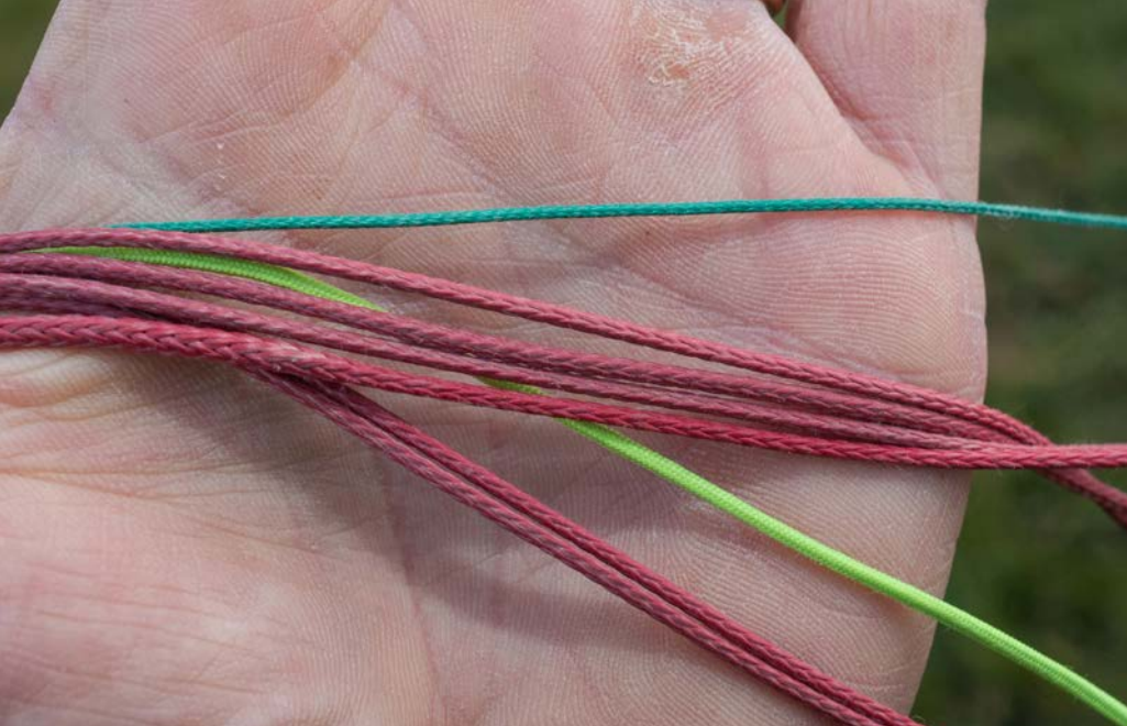
Les suspentes non gainées de l'Air Design UFO 16, majoritairement en Edelrid Aramide.
