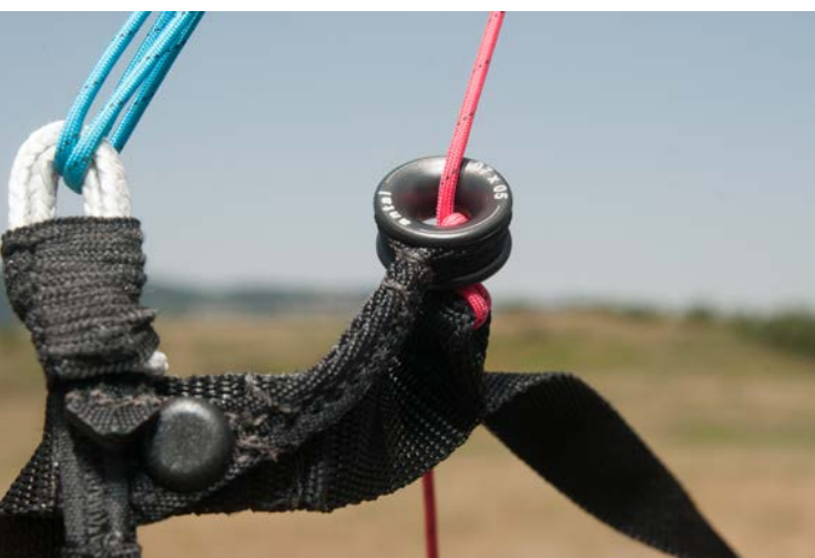
Évidemment, une bague de friction remplace la poulie de frein sur cette aile ultralégère.
