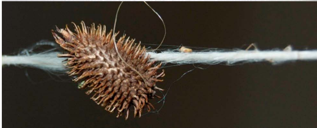
Les suspentes non gainées sont facilement victimes du peluchage. Photo : Trekking
