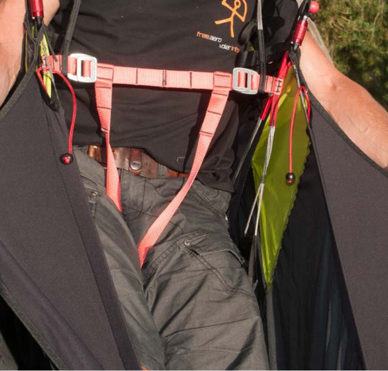
Skywalk Range Air : des sangles et des boucles pour la fermeture
