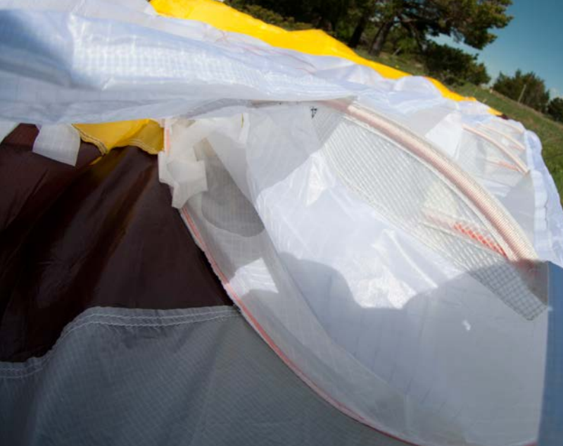
Air Scoop, le Shark Nose de Nova. Photo : voler.info
