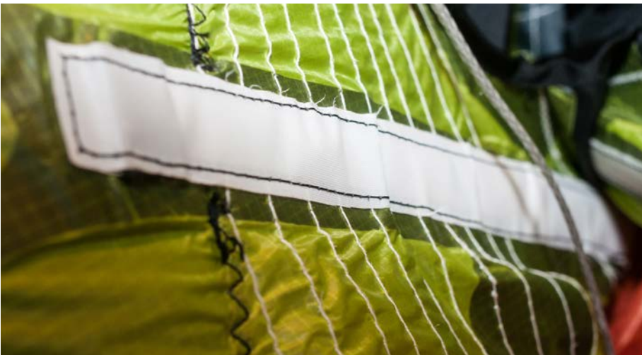
Des lattes en fibre de verre pour les efforts en compression
