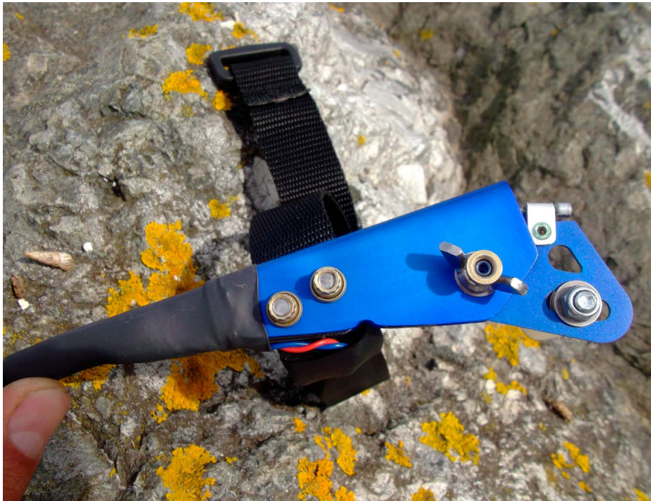
La gaine est très souple et accepte de prendre des rayons de courbure très serrés, sans pour autant coincer le câble.
