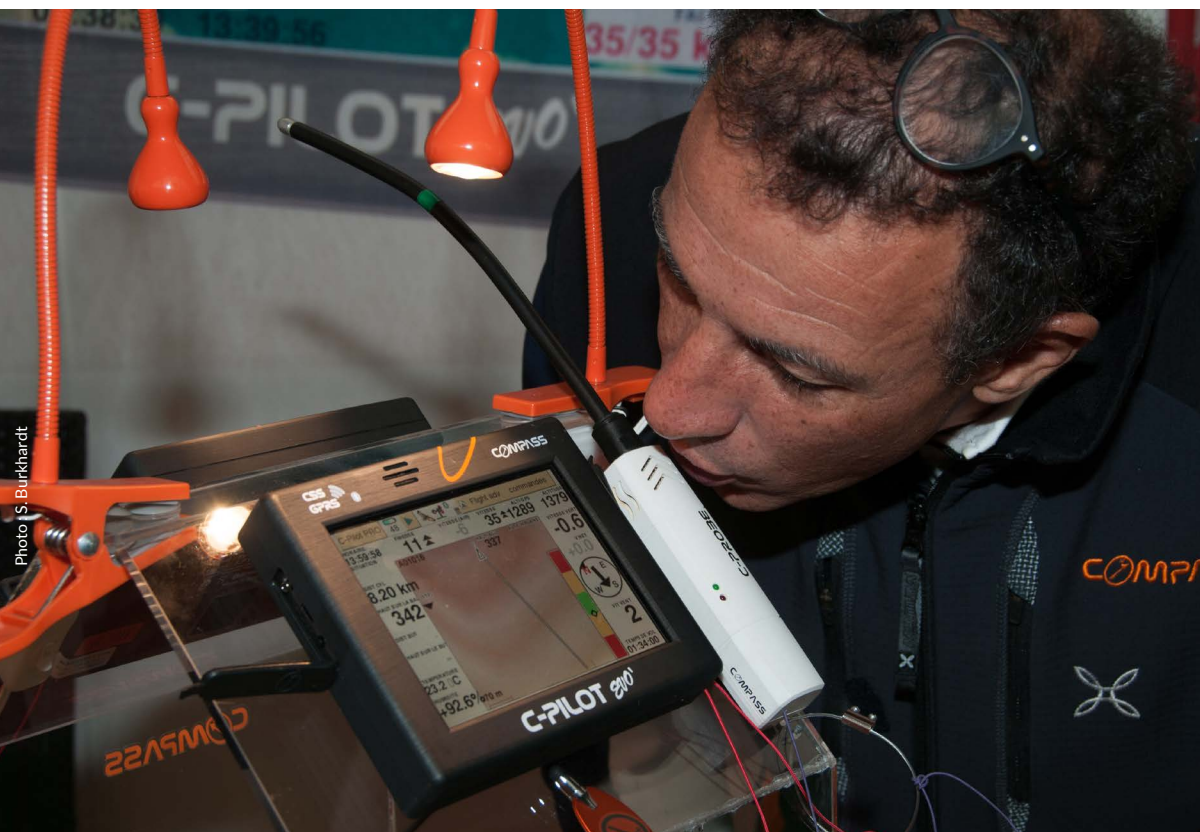
Le capteur de vitesse intègre l'humidité pour une plus grande précision de la TAS.
